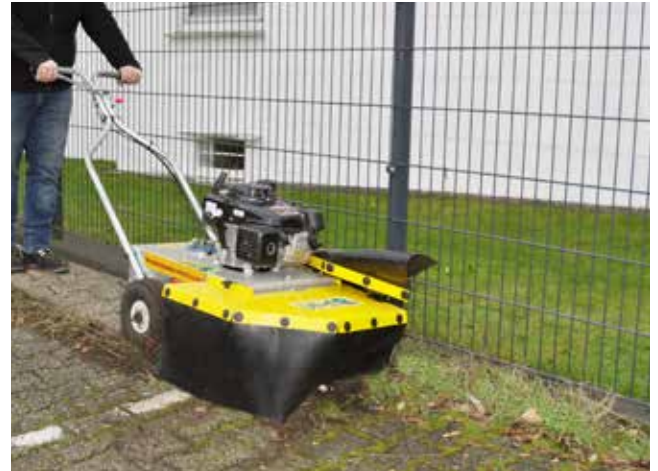
Schwadformer / Spritzschutz kann werkzeuglos angebracht werden.
